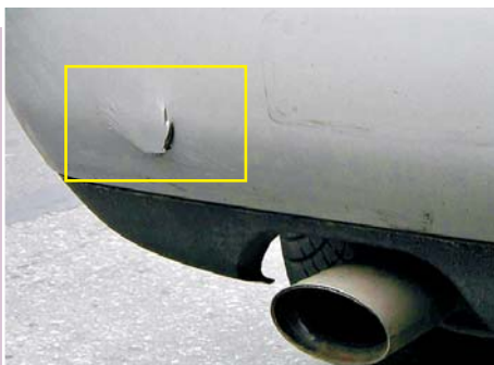
Фото 11. От удара сзади треснула облицовка бампера в месте его крепления к кузову. Завод-изготовитель предписывает заменить поврежденный бампер, но некоторые специализированные фирмы его ремонтируют.
