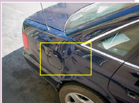
Фото 4. Складка на крыле появилась от удара сзади, а не сбоку, значит, деформирован силовой элемент кузова.
