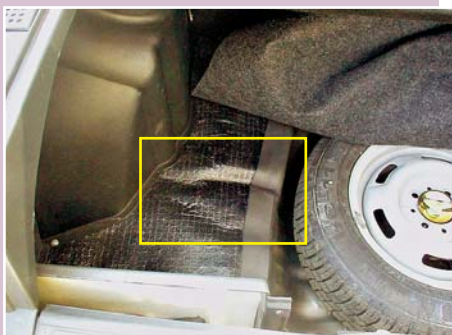
Фото 3. Складка на полу багажника.
