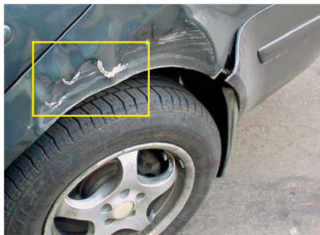
Фото 9. Большая площадь повреждений в труднодоступном месте — целесообразно заменить крыло.
