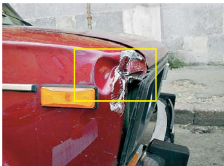
Фото 8. Острые складки, вытяжка металла на краю детали — затруднено восстановление геометрии края крыла, лучше его заменить.
